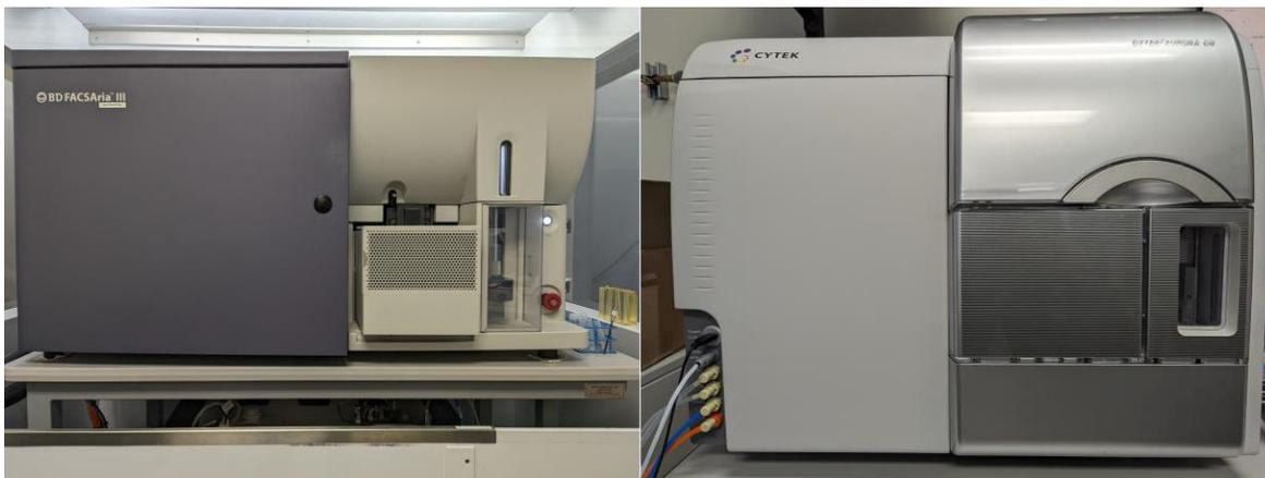
Le BDFACSAriaIII et le Cytek Aurora CS sont tous deux des trieurs de cellules à jet d'air. Essentiellement, en utilisant la technique de focalisation hydrodynamique, ces instruments alignent les cellules, contenues dans un échantillon, les unes à la suite des autres. Par la suite, ces cellules, marquées avec des fluorochromes, seront frappées par des lasers permettant d'identifier les cellules d'intérêt. Le flux continu transportant les cellules de
