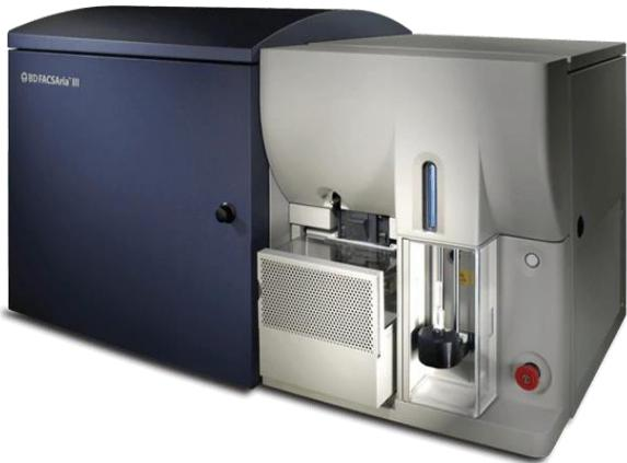
Le BD ARIA III est équipé de 4 lasers qui permettent la détection de 16 paramètres de fluorescence en plus des paramètres de taille (FSC) et de structure (SSC).
